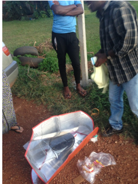
Imagen 3: Cocina solar fabricada a partir de materiales caseros, con capacidad para 10l (apta para las familias integrantes de las Cooperativas de Mujeres Ganaderas).
